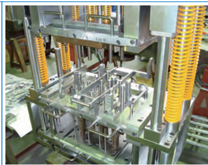
アルミダイカスト製品トリミング金型
