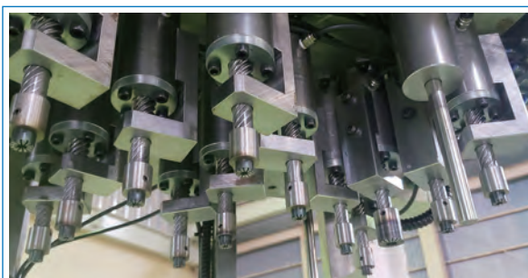
EP縦バリ取りトリミング金型 上部 (精密トリミング設備上部)
