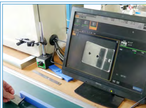
CAD/CAMによる加工図作成。画像センサーシステムによる製品検査 ■ 製品の一部（金具部門・建材関連部品）
