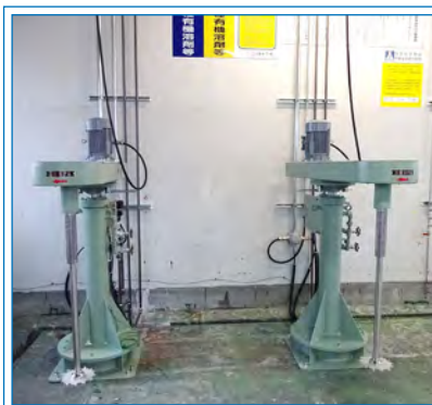
■ 塗料を調色する際に使用する攪拌機
