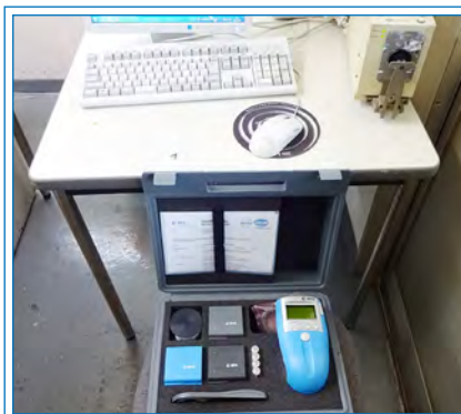
■ コンピュータと測色計で色差管理します
