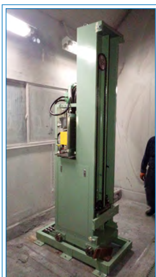
■ 塗装ラインで使用・レシプロ塗装機
