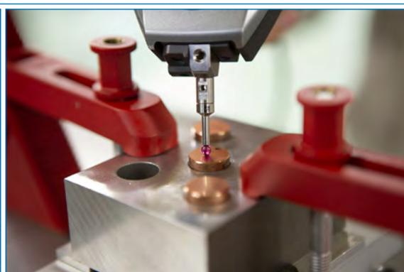
■ 顧客の単品小ロット部品も対応 精度の高い製品は3次元測定器で計測管理
