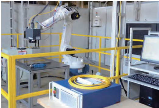
ファイバーレーザ高速微細加工装置●
