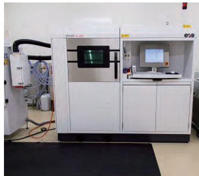
金属積層造形装置 (金属3Dプリンター)●
