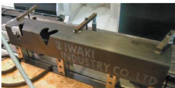
図4 大型CFRP材の5軸加工例
