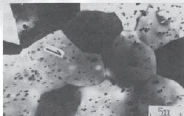
5083 合金の透過電子顕微鏡組織
