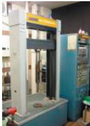
引っ張りジグ部分は掴み部のゆめを無くすために、大阪大学の旧研究室から図面を頂いて、上谷先生が強度計算をし直し、当工学部の機械工場で作製したものである。
