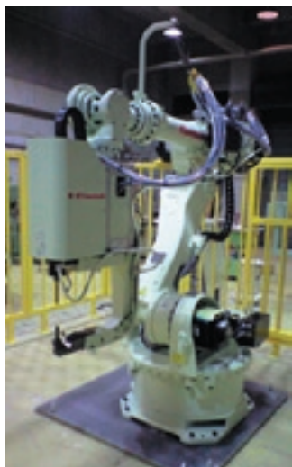
図 1 摩擦攪拌スポット接合装置
