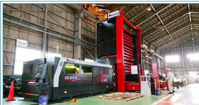
■ ファ이버レーザー切断加工機 (パレットチェンジャー付)
