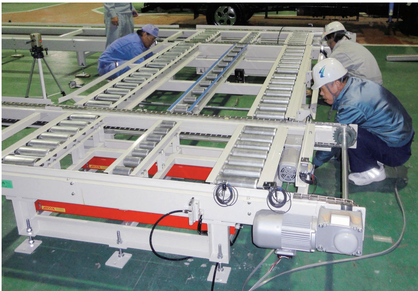
搬送ライン架台
