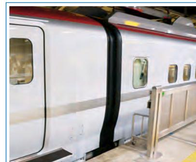
新幹線車両連結部の整流ゴム
